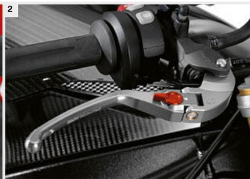
HP Kupplungshebel klappbar (Abbildung 1)
