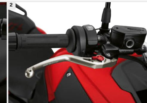
HP Kupplungshebel gefräst (Abbildung 1)
