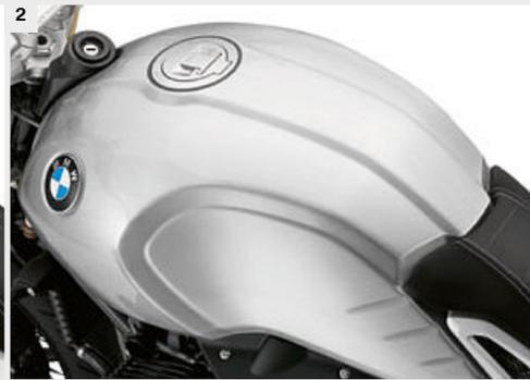
Aluminium-Tank handgebürstet, mit sichtbarer Schweißnaht (Abbildung 1)
