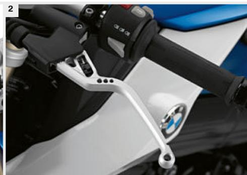
**HP Handbremshebel gefräst**(Abbildung 1)
