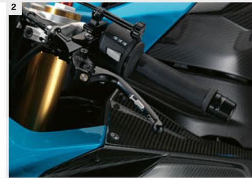
**HP Handhebel klappbar** (Abbildung 1)
