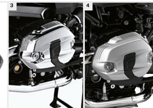
Zylinderkopfhaube 2V-Style (Abbildung 1)
